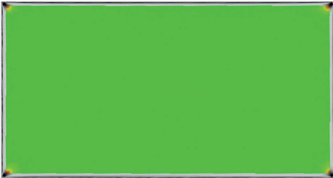
Anisotropie-Scan eines 6m x 3,2m 10mm sedak tempered+ ESG Glases mit einem 95%-Quantilwert von \leq 60\text{nm} .
